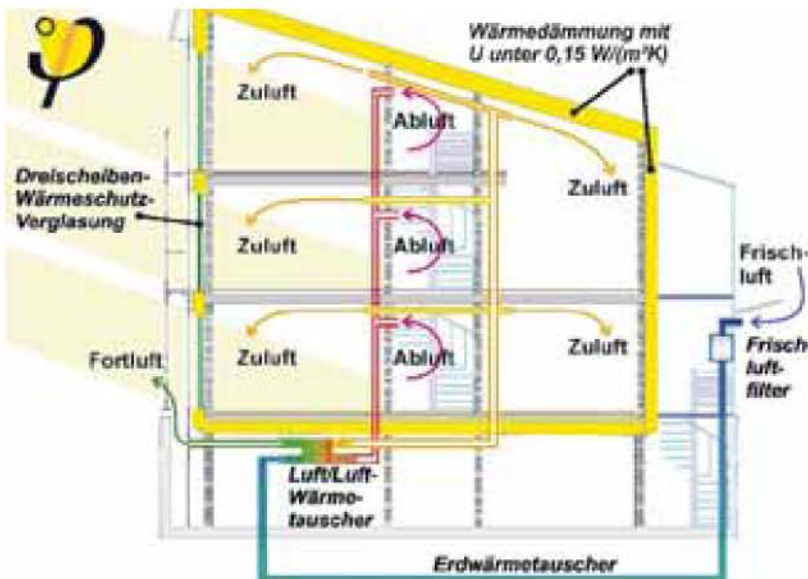
Schematischer Querschnitt durch ein Passivhaus.
